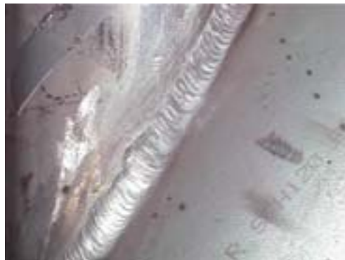
Mechanické zpracování povrchové plochy svarového spoje: Cílem není zarovnání svarového spoje, nýbrž odstranění náběhové barvy v jeho okolí.
