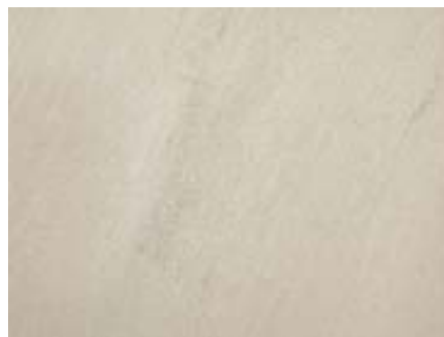
Po odstranění okují a moření je povrchová plocha od výrobce matově šedá. Mechanické odstranění okují přitom vede k zdrsnění povrchu.
