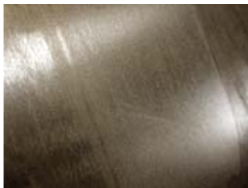
Během válcování za tepla vzniká na povrchové ploše korozivzdorných ocelí černošedá oxidická vrstva, kterou odstraňuje výrobce odstraněním okují.
